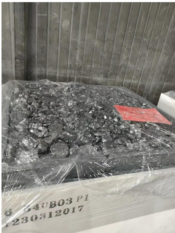
多晶硅料填料前状态（块状）
