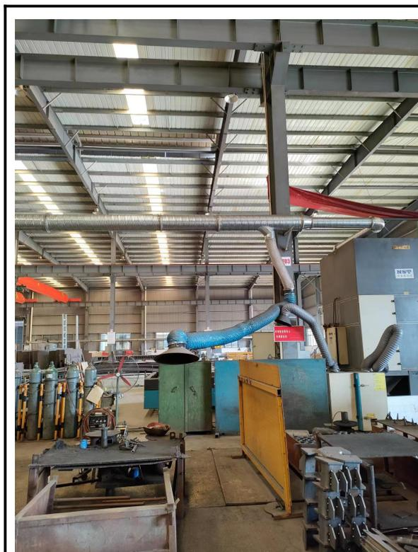
焊接废气收集罩
