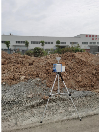
厂界外无组织废气监测采样
