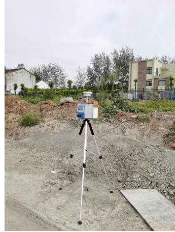
厂界外无组织废气监测采样
