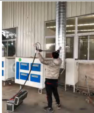
2#排气筒有组织废气监测采样
