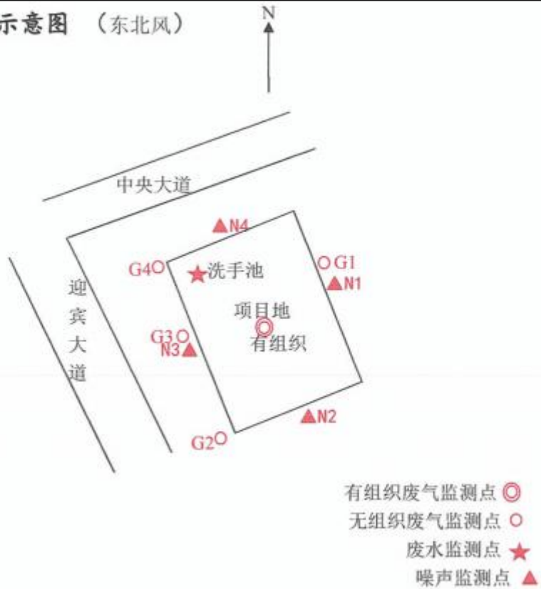
图 6-1 项目生活污水、废气、噪声监测点位示意图
